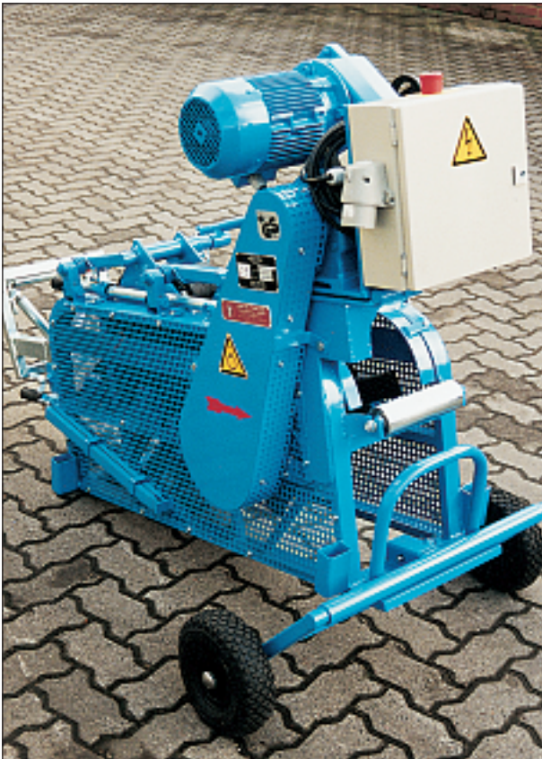
Kabelverlegemaschine „Kabelhund“ mit Elektromotor Cable Laying Machine „Cable Dog“ with electric engine
