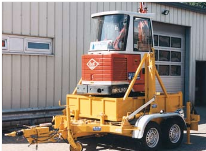
„TTA 2091“ abgebildet mit einer Verladepritsche z. B. für Bagger „TTA 2091“ with stake body for excavators etc.
