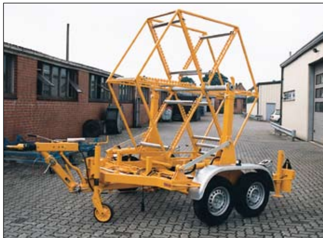
„TTA 2091“, abgebildet mit einem Rohrabwickelgerät Typ „RAW 2200“ (2 Stück transportierbar) „TTA 2091“ with 1 tube coil frame type "RAW 2200" (2 units can be transported)
